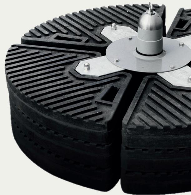
Der freistehende Weight Angel Anschlagpunkt besteht aus mehreren aufzulegenden Gewichten, zusammengesetzt zu einer runden Einheit. Eingesetzt in Verbindung mit einem integriertem Kraftabsorber ist der Weight Angel ein leistungsfähiger Gewichtsanker, der souverän jeden Sturz aushält.
