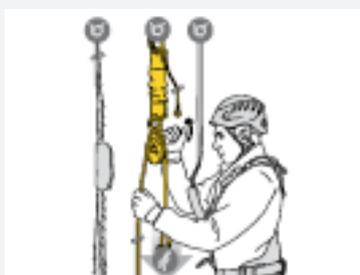
Evakuierung mit Hilfe des I'D S-Abseilgeräts, dessen ergonomisch geformter Griff eine effiziente Kontrolle des Seildurchlaufs beim Abseilen ermöglicht.
