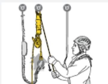
Heben mit Hilfe des Flaschenzug-Sets JAG SYSTEM mit 4:1-Übersetzung und Laufrollen mit ausgezeichnetem Wirkungsgrad, bei dem der Anwender zum Hochziehen und Lösen des Verletzten nur ein 1/4 der Kraft aufwenden muss.
