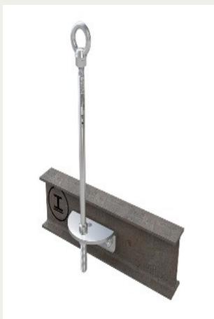
Lock III-Seitl-65 für die seitliche Montage auf Stahl. Er eignet sich damit besonders für verschiedene Anwendungsfelder der Industrie. Der Edelstahl-Anschlagpunkt (Ø 16mm) wird mit einer Winkelplatte befestigt. Diese wird durch den Untergrund gekontert, beispielsweise durch tragende Stahlträger. Das erforderliche Befestigungsmaterial gehört zum Lieferumfang.
