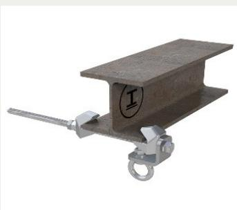
Unkompliziert montiert, fast unverwüstlich. Der Anschlagpunkt ABS-Lock T wird mit seinen Trägerklammern um den Flansch Ihrer Stahlträger geklemmt und kann dann flexibel als Absturzsicherung verwendet werden. Der ABS-Lock T sichert als einzelner Sekurant bis zu 3 Personen, ist in jede Richtung belastbar und außerdem als Systemkomponente in Seilsicherungssystemen sehr variabel nutzbar: als Zwischenstütze, Kurventräger oder Befestigung für Endterminals.
