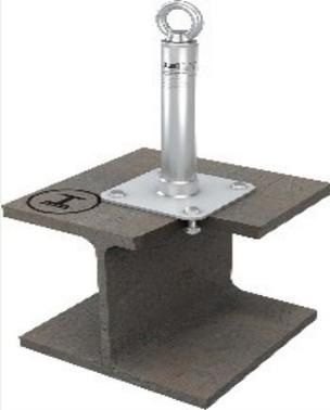
Lock X-SR-ST sitzt auf einer Edelstahl-Grundplatte und ist somit bestens für die Verwendung als tragendes Element in Seilsicherungssystemen geeignet. Die Grundplatte wird mit 4 Schrauben und Muttern durch Stahlunterkonstruktionen gekontert und hält der Vorspannung in Seilsicherungssystemen problemlos stand. Dank der variablen Stützhöhe können Sie das Seilsicherungssystem sehr flexibel nach Ihren Bedürfnissen planen
