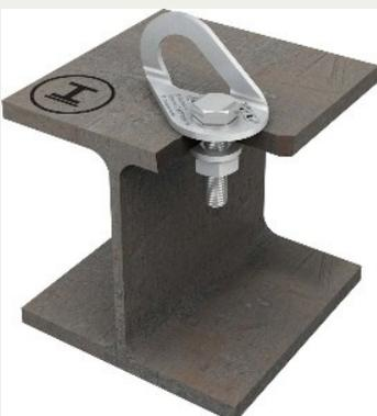
Lock V-ST wird durch tragfähige Stahluntergründe gekontert oder direkt im Untergrund verschraubt. Seine Öse bietet 1 Person eine sichere Anschlagmöglichkeit. Schützen Sie Ihre Mitarbeiter an Absturzkanten und höher gelegenen Arbeitsplätzen mit dieser unkomplizierten und unauffälligen Absturzsicherung.
