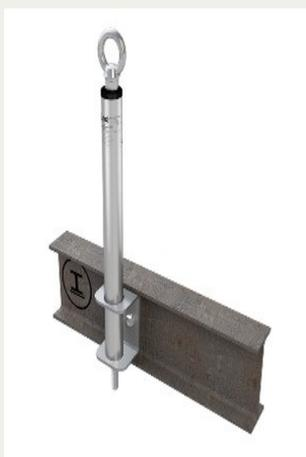
Lock III-SEITL-SR ist ein besonders robuster Anschlagpunkt. Diese Sekuranten bieten Ihnen eine gute Absturzsicherung in Industrie, Bau und Handwerk. Mit einem Edelstahlstützrohr (Ø 42mm) sind sie speziell für den Einsatz in Seilsicherungssystemen verstärkt; sie können aber auch problemlos als Einzelanschlagpunkte verwendet werden. Installieren Sie diese Sekuranten ganz nach Ihren Bedürfnissen am Boden, an der Wand oder der Decke.
