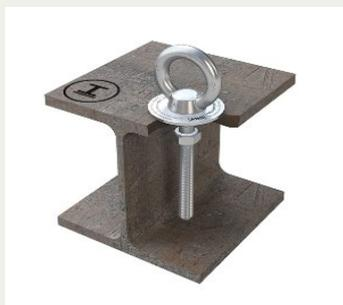
Der Edelstahl-Anschlagpunkt Lock IV-ST für Stahl bietet Ihnen 2 Montagevarianten: Er wird entweder mit einer Mutter gekontert oder direkt in ein bauseitig vorhandenes Gewinde (M12) geschraubt. Unabhängig davon, für welche Installation Sie sich entscheiden, kann die Anschlageinrichtung in jede Belastungsrichtung genutzt werden.
