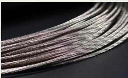
Das 7 x 7 8 mm Edelstahlseil hat aufgrund des Materials eine sehr hohe Korrosionsbeständigkeit und rostet somit nicht. Unser Edelstahlseil kann wahlweise auch in rot und schwarz lackiert werden. Die Mindestbruchlast des Edelstahlseils liegt bei 36,1 kN. Unser Edelstahlseil kann auch vorkonfektioniert geliefert werden.
