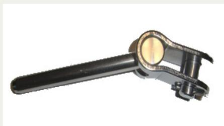
Das Endelement bildet den Abschluss des Absturzsicherungssystems. Es ist an einer variablen Gabel befestigt, um die Seilführung auszugleichen. Das Endelement wird mit dem Edelstahlseil mittels einer zertifizierten Hydraulikpresse verpresst, um einen optimalen Absturzsicherungsschutz zu bieten.
