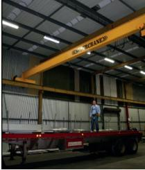
Beim Beladen von Tieflastern kann die Beurteilung des Absturzrisikos problematisch sein, da herkömmliche Schutzvorrichtungen nicht ausreichen, um einen Aufprall am Boden zu verhindern. Das T-Line kann selbst in diesen Fällen schützen und erlaubt dem
