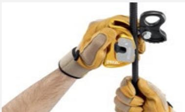
Der geführte Reibnocken lässt sich öffnen und ermöglicht es, die Seilklemme überall am Seil aufzusetzen und abzunehmen.
