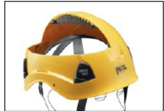
Die VERTEX-Helme verfügen über eine 6-Punkt-Textilaufhängung, die eine optimale Passform und maximalen Tragekomfort gewährleistet. Stöße und Schläge werden durch Deformierung der Innenschale absorbiert. Gewicht: 455 g
