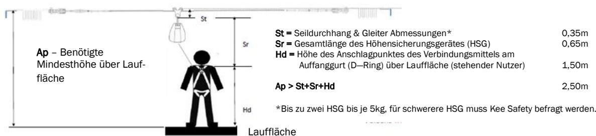
Abbildung 1 – 3.2.2.1 Mindesthöhe des KeeLine® Über-Kopf-Seilsicherungssystem über der Lauffläche
