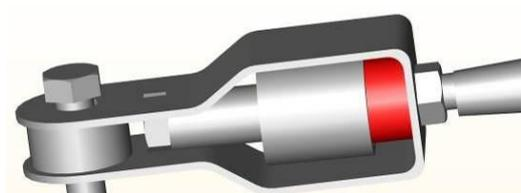
Abbildung 26 – Ungespannte Spannungsanzeige
