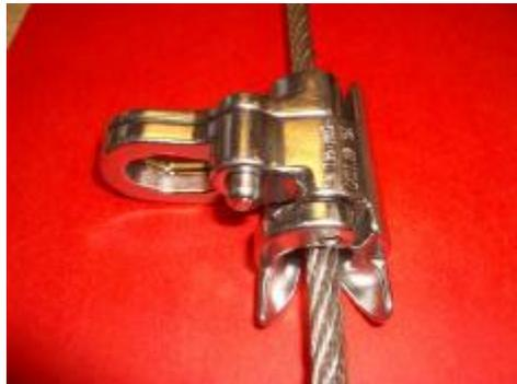
Befestigen Sie Sicherungsseil oder Falldämpfer an der Befestigungsöse des Gleiters und verschließen Sie den Karabiner oder Gerüsthaken.
