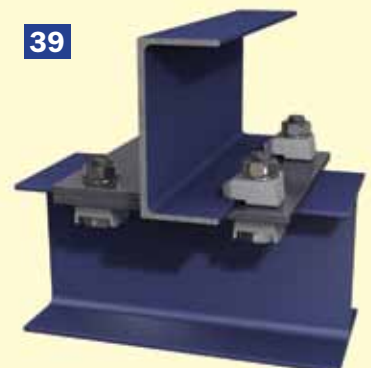
U-Träger um 90° versetzt an oberem Flansch fixiert
