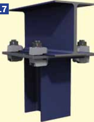
Horizontal laufender Träger auf Stütze
