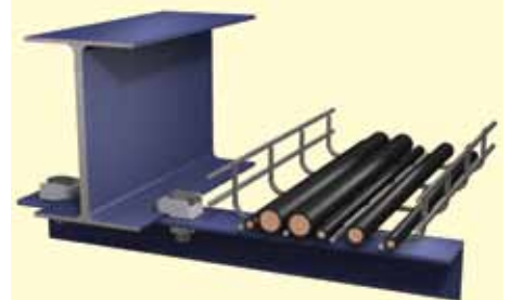
Winkelprofil als Träger für Kabelkanal an Stahlträger
