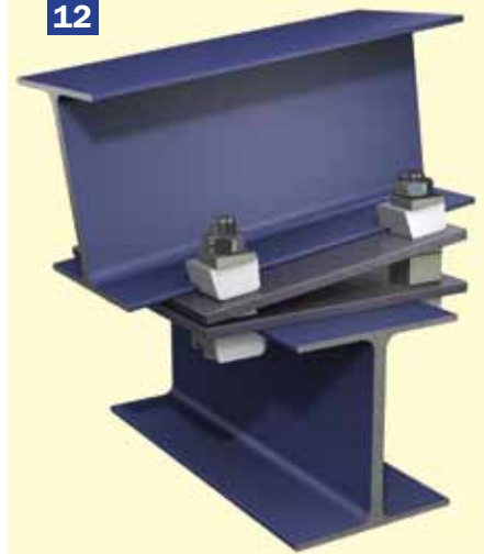
Um 90 Grad versetzte, mittels Distanzstücken geneigte Trägerverbindung
