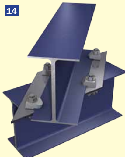
Versetzte Trägerverbindung (Winkel \neq 90 Grad)
