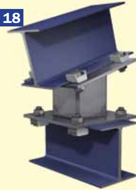
Um 90 Grad versetzte Trägerverbindung mit geneigtem Montagegestützen
