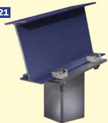
Geneigte Verbindung eines Trägers an einem Hohlprofil
