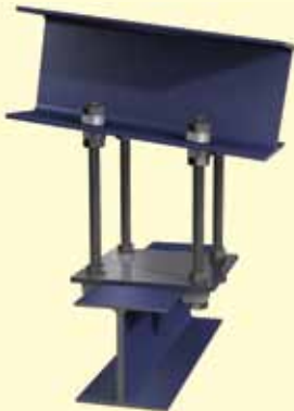
Träger an geneigtem Träger mit Zwischenraum
