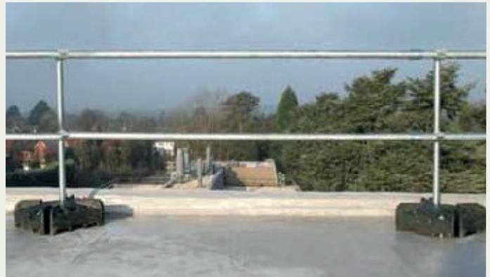
Die aus recyceltem PVC hergestellten Gewichte bestehen aus zwei Teilen, die miteinander verschraubt werden. Sie können somit entweder einzeln von je einer Person transportiert werden oder im fertig montierten Zustand von zwei Personen. Eingearbeitete Tragegriffe ermöglichen die einfache Handhabung der Gewichte. KEEGUARD Premium ist dank der vorgefertigten Pfosten und durch die Verwendung der bewährten KEE KLAMP Rohrverbinder schnell und einfach montiert.
